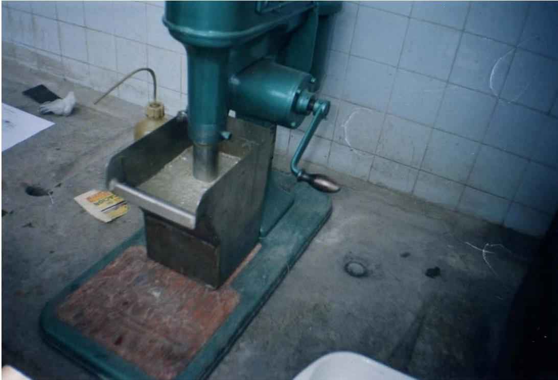
**Prueba de flotación (laboratorio)**
